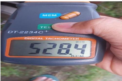
Gambar 7. Hasil Pengukuran Turbin
