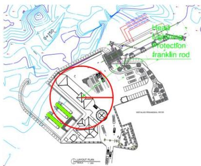
**Gambar 6.** Radius proteksi Desain Perhitungan Dengan *Franklin Rod*.
