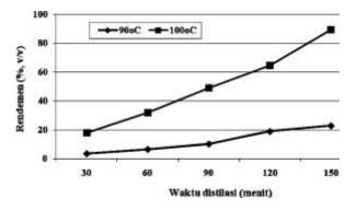
**Gambar 1.** Grafik hubungan rendemen dan waktu distilasi pada masing-masing suhu
