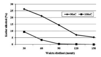
**Gambar 3.** Grafik hubungan kadar alkohol dan waktu distilasi pada masing-masing suhu
