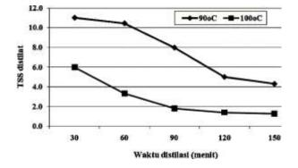
**Gambar 5.** Grafik hubungan total padatan terlarut dan waktu distilasi pada masing-masing suhu
