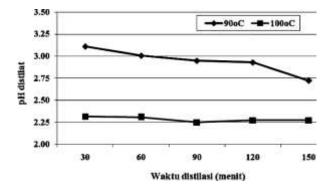
**Gambar 4.** Grafik hubungan pH distilat dan waktu distilasi pada masing-masing suhu
