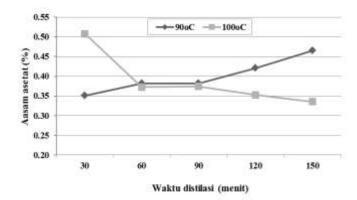
**Gambar 2.** Grafik hubungan asam asetat dan waktu distilasi pada masing-masing suhu
