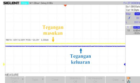
Gambar 17: Tegangan keluaran pada implementasi perangkat keras *cuk converter* dengan metode PI referensi 0.5 A.
