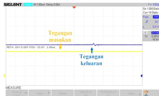
Gambar 19: Tegangan keluaran pada implementasi perangkat keras *cuk converter* dengan metode PI referensi 3 A.
