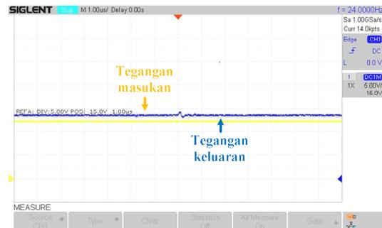
Gambar 18: Tegangan keluaran pada implementasi perangkat keras *cuk converter* dengan metode PI referensi 1.5 A.
