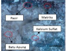
Gambar 10. Foto micro specimen perendaman 10% natrium sulfat dengan pembesaran 5x
