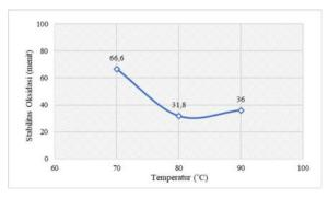
Gambar 4. Grafik pengaruh temperatur pada putaran 500 rpm terhadap stabilitas oksidasi
