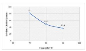
Gambar 5. Grafik pengaruh temperatur pada putaran 750 rpm terhadap stabilitas oksidasi
