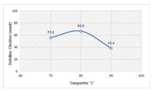
Gambar 3. Grafik pengaruh temperatur pada putaran 250 rpm terhadap stabilitas oksidasi
