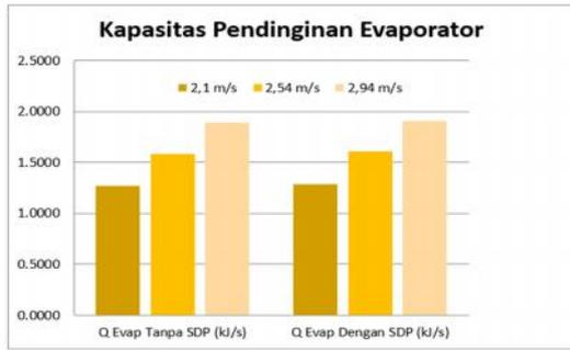
**Gambar 6. Gambar kapasitas pendinginan dengan menggunakan *in – line* SDP dan tanpa menggunakan *in – line* SDP**
