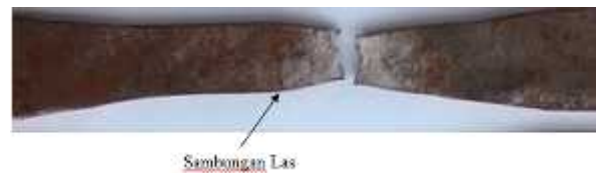
Gambar 6. Material patahan uji tarik dengan elektroda E 6013
