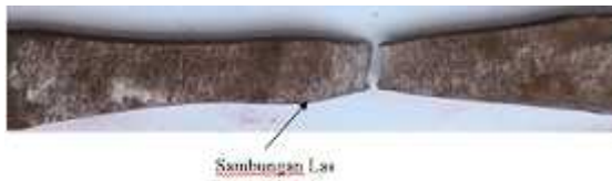
Gambar 8. Material patahan uji tarik dengan elektroda E 7016
