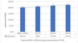
Gambar 4. Grafik Pengujian Vickers
