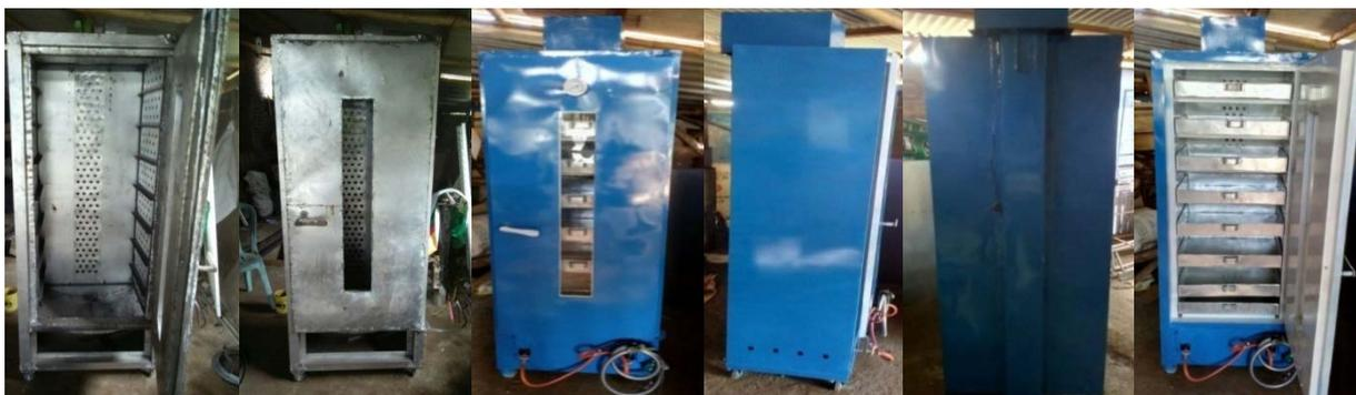
**Gambar 2.** Alat Pengering Tipe Kabinet Dilihat Berdasarkan Proses Pembuatan Dan Beberapa Posisi
