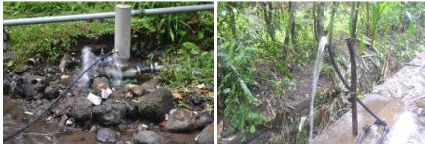
Gambar 16. Foto uji coba pompa hydram, uji kapasitas pemompaan
